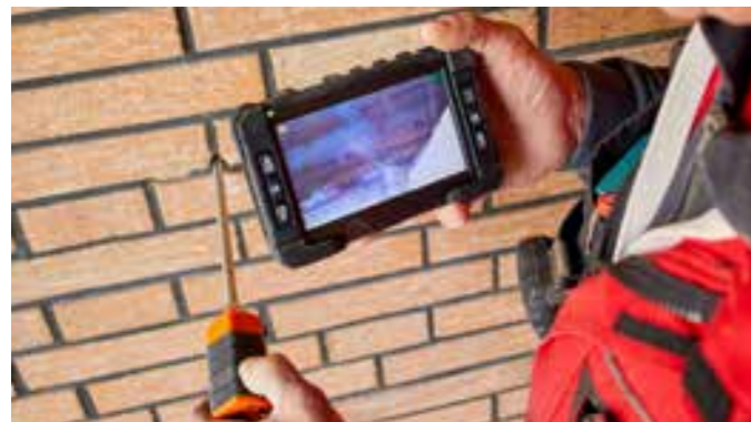
Zu Beginn wird die Wand bzw. die Hohlschicht an mehreren Stellen mittels eines Endoskops auf ihre Beschaffenheit hin untersucht.
